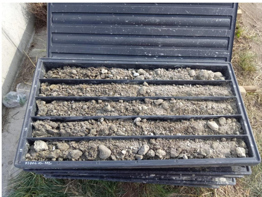
SONDAGGIO OS_PZ1P: Cassa n.6 da 25.00 a 30.00 m
