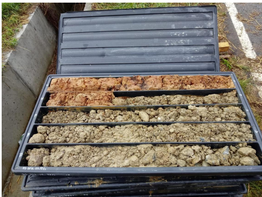
SONDAGGIO OS_PZ1P: Cassa n.8 da 35.00 a 40.00 m
