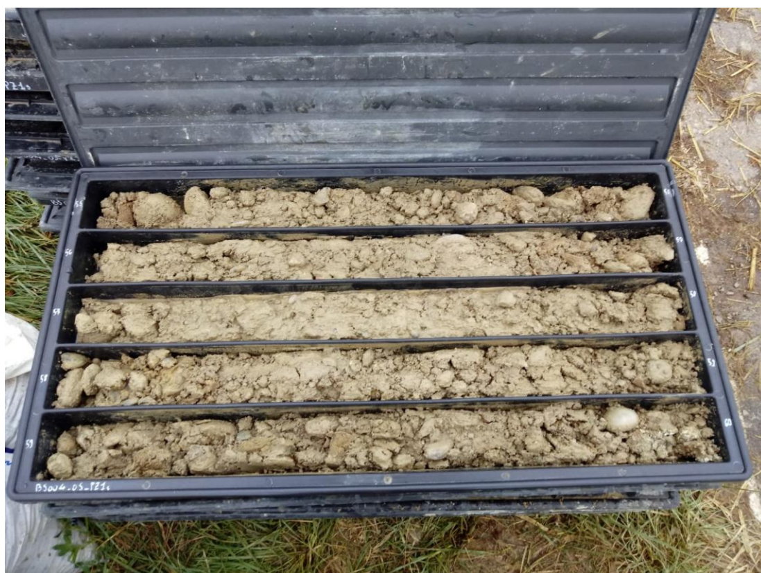
SONDAGGIO OS_PZ1P: Cassa n.12 da 55.00 a 60.00 m
