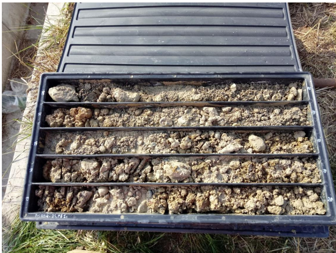
SONDAGGIO OS_PZ1P: Cassa n.4 da 15.00 a 20.00 m
