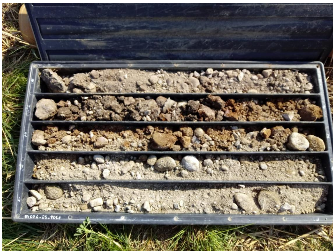
SONDAGGIO OS_PZ1P: Cassa n.1 da 0.00 a 5.00 m
