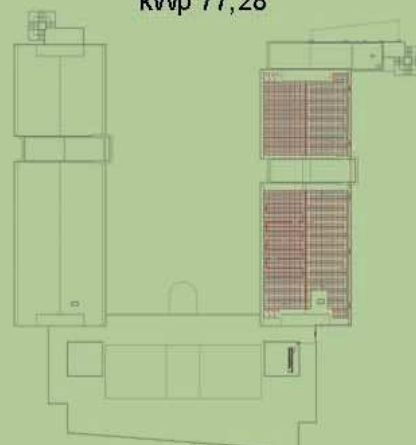
Impianto fotovoltaico kWp 77,28
